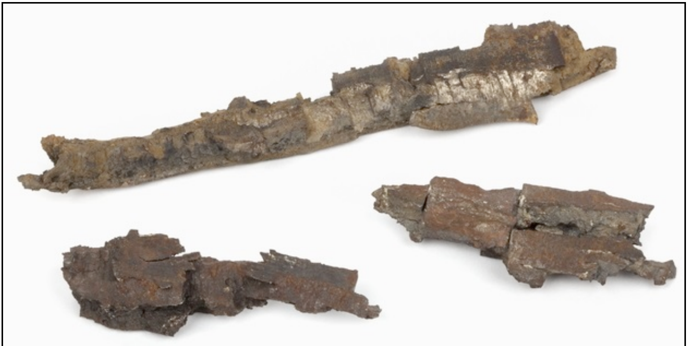
Afbeelding 2. Scherven afkomstig van een projectiel gevuld met springstof, na detonatie.
