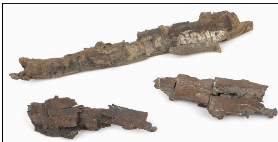
Afbeelding 6. Scherven afkomstig van een projectiel gevuld met springstof, na detonatie.
