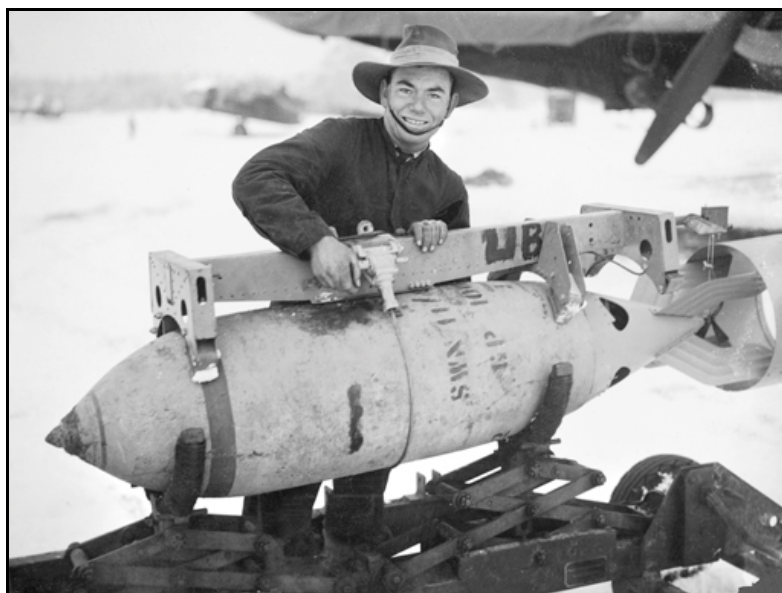
Afbeelding 4: Voorbeeld van een Britse 1000 lb. GP brisantbom. Op de foto is de bom gereed om te worden geladen in een bommenwerper van No. 455 Squadron RAAF op de vliegbasis RAF Swinderby, Lincolnshire, Engeland, februari 1942 (Bron: http://www.dva.gov.au ).
